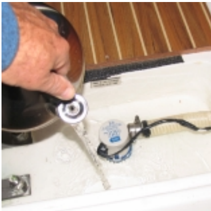
De bilgepomp even testen met water
