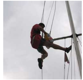
Onderhoud met gebruik van het bootsmansstoeltje; spullen mee via een aparte lijn en plastic zak, rondom de mastvoet kussens tegen vallend gereedschap
