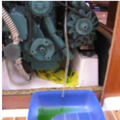
Hang tijdens het vullen het overloopslangetje in een bakje. Er lekt toch wat koelvloeistof uit. Vul via de vuldop circa 2 liter koelvloeistof bij. Het niveau dient net onder de dop te staan. Met je vinger voel je in de dop een object, daar moet de vloeistof net boven staan. Raadpleeg de handleiding.
