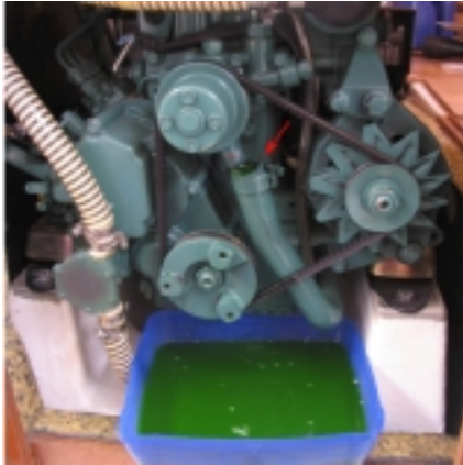
Na het losdraaien van de slangenklem en los nemen van de leiding gultst de koelvloeistof naar buiten
