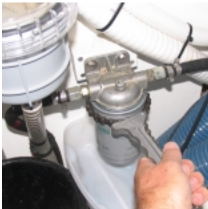
Losdraaien van het filter
