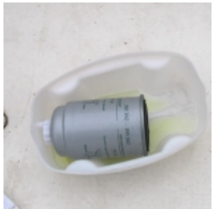
Afvoeren van het filter en diesel
