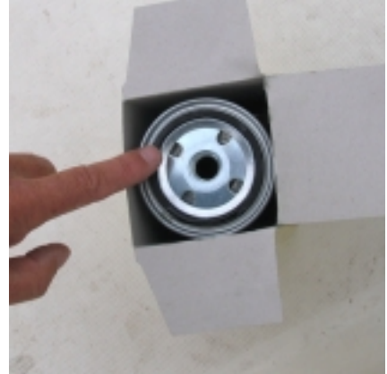
Insmeren van de afdichting met olie
