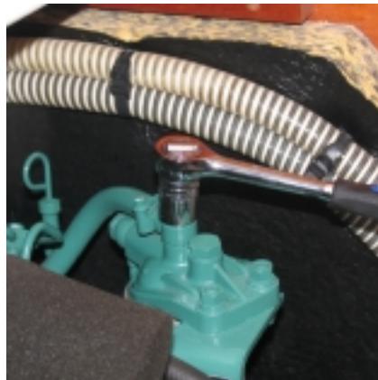
Losdraaien van het ontluichtingspunt / sleutel 18
