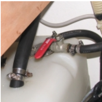
Motor aan en Brandstofkraan dicht
